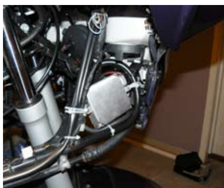
Montering av ballasten (Blank, firkantet boks). Ballasten er stripset på plass og sitter i åpningen foran på kåpa for god kjøling.
